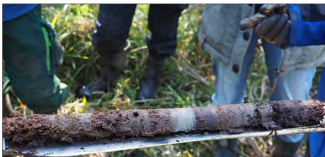
Abbildung 12: Profilbohrung mit der Moorklappsonde, beispielhaft für das Untersuchungsgebiet Oberrospe. Die kartierten Moorböden waren meist gekennzeichnet von einem Wechsel aus organischen Torfen (dunkle Farbe) und mineralischen Auensubstraten (hellgraue Farbe); Foto: HLNUG.
