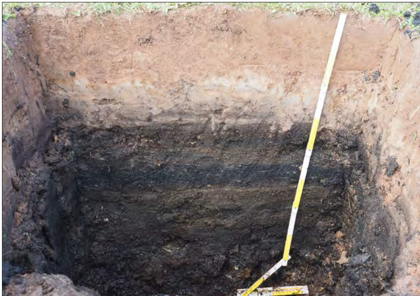
Abbildung 11: Bodenprofilgrube für die bodenkundliche Ansprache und die Beprobung eines ehemaligen Durchströmungs- und Auenüberflutungsmoores am Standort Todenhausen. Der etwa 35 cm mächtige mineralische Oberboden überdeckt die darunter anschließenden Torfe aus Braunmoosen, Schilf und Radizellen; Foto: HLNUG.
