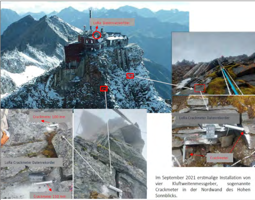
Abbildung 14: Crackmeterstandorte in der Sonnblick Nordwand; Quelle S. Reisenhofer. Figure 14: Crack metre locations in the Sonnblick north face; source S. Reisenhofer.
