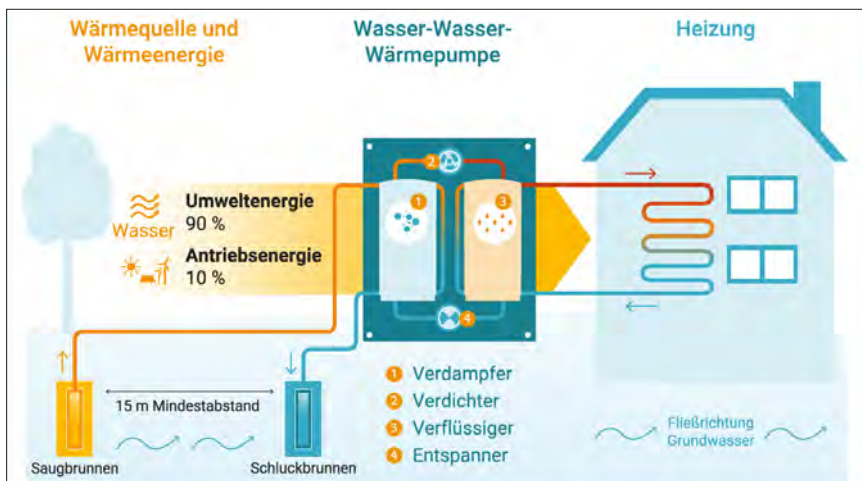
Abbildung 3: Prinzip einer Wärmepumpe mit geschlossenem Kreislauf auf Grundwasserbasis; Quelle: co2online.
